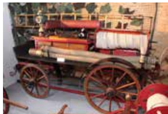
Motorová hasičská stříkačka, čtyřkolová, záprahová, od firmy Bohumil MĀRA, pravděpodobně rok výroby 1931 včetně příslušenství. Stříkačka je funkční s kompletním vybavením. Naposledy byla použita u požáru v roce 1963. Zakoupena byla od obce Unětice.
